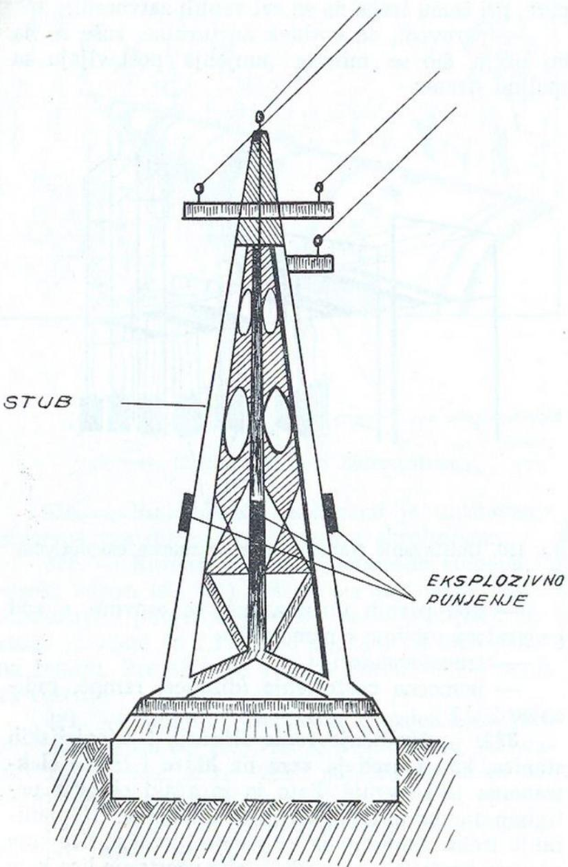
Sl. 151. Rušenje armirano-betonskih stubova za visoki napon
